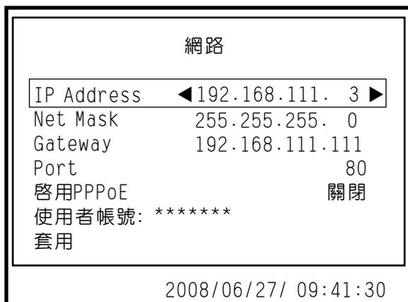
(1) IP Address：網卡所設定的IP，可由DVR更改IP
